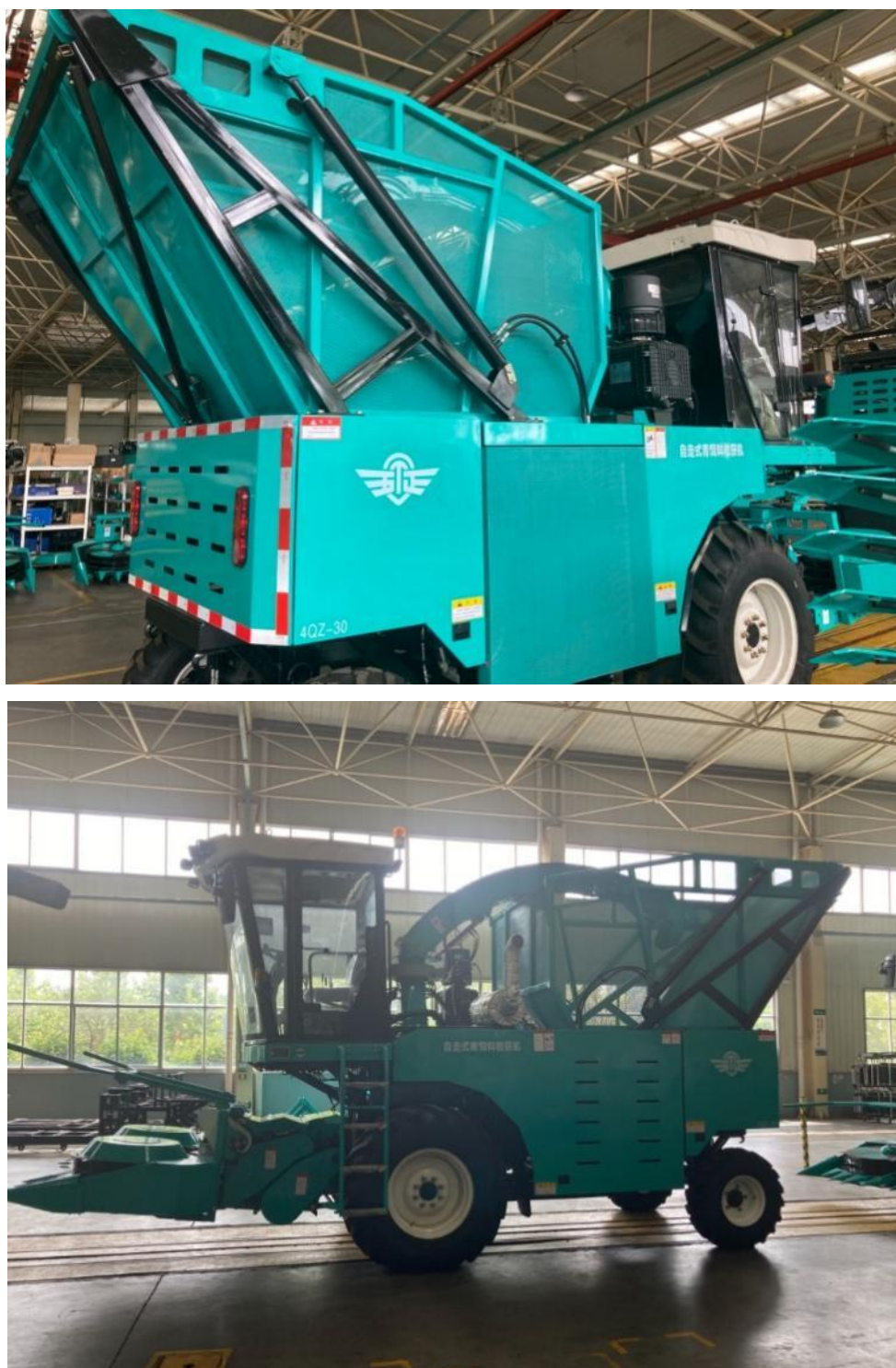
收割、铡短一体的饲草收割机械 (可投资 20-30 万元，组建农机专业合作社，每天或每两天轮流帮周围的 50-60 个养牛户，统一收割、运输到场鲜喂)
